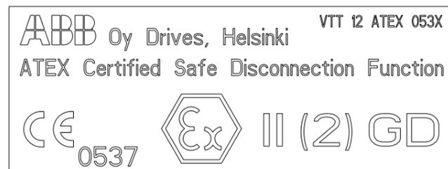
Exemple de marquage de dispositif de protection. Les parenthèses indiquent qu'un dispositif de sécurité peut être utilisé pour protéger des produits de catégorie 2, mais le dispositif de sécurité lui-même et le variateur dans lequel il est intégré, sont installés dans une zone sûre.
